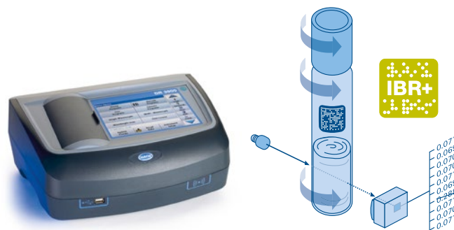
Izquierda: espectrofotómetro DR3900 Derecha: La cubeta gira y el fotómetro la mide en diez puntos diferentes durante un solo giro, eliminando los valores erróneos
