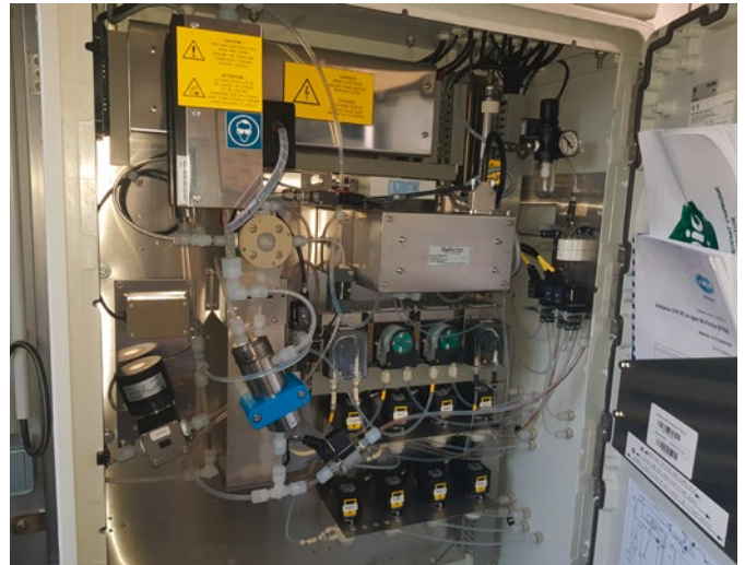
Analizador de TOC/TN Biotector B7000 de 6 corrientes
