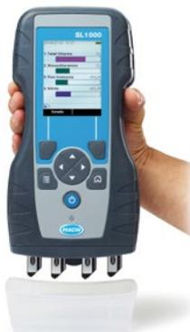
**SL1000** es un medidor portátil que puede medir hasta seis parámetros simultáneamente, lo que hace que el análisis sea más rápido. Una solución excelente para aplicaciones de agua de caldera. El SL1000 es un 75 % más rápido que los test que requieren sobres de reactivo en polvo. No hay ninguna alternativa competitiva al SL1000.
