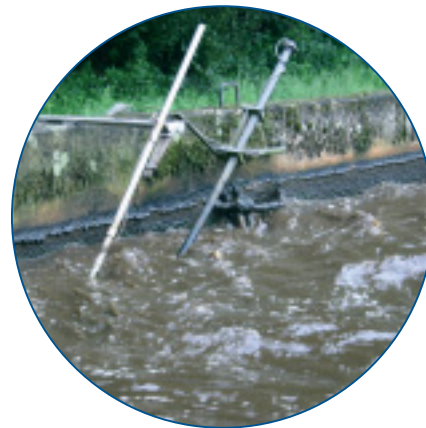
Fig. 7: El sensor LDO funciona normalmente hasta en los entornos más difíciles. Los requisitos de mantenimiento siguen siendo mínimos.
