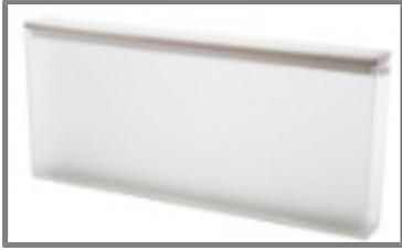
**Celda de muestra: vidrio rectangular de 10 cm Longitud de recorrido óptico 100 mm**
